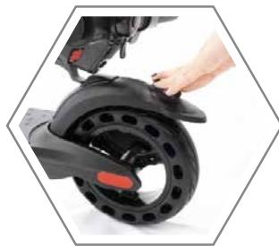
Lösen Sie die Lenkerstange, indem Sie Druck auf das hintere Schutzblech ausüben
