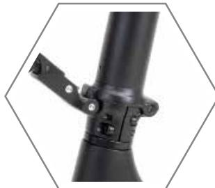
Coloque la barra del manillar en posición vertical
