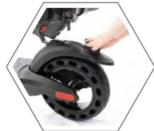
Richten Sie den Hebel am Befestigungspunkt auf dem Schutzblech aus und verbinden Sie beide
