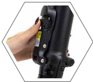
Schließen Sie den Schnellspannhebel.
