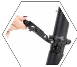
Lösen Sie die Fahrstange, indem Sie den Hebel nach außen ziehen
